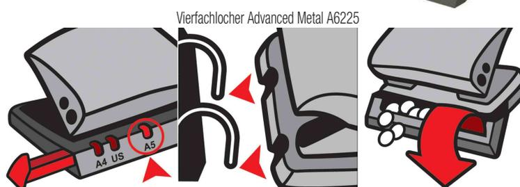
Anschlagsschiene - System zum Zentrieren - Entleerungsklappe
