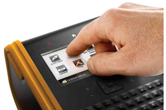
Detailansicht: Farbdisplay mit Touchscreen
