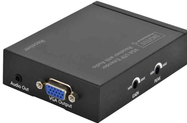
VGA-UTP Extender Empfängereinheit
