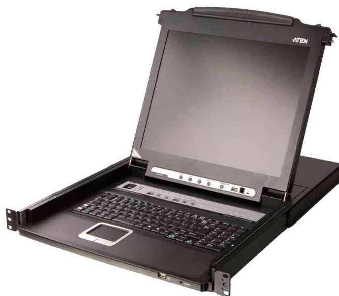
17" KVM Konsole mit 43,18 cm (17") LCD-Monitor
